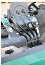
**Hydraulische bedieningshendels** zijn goed bereikbaar en gebruiksvriendelijk.
